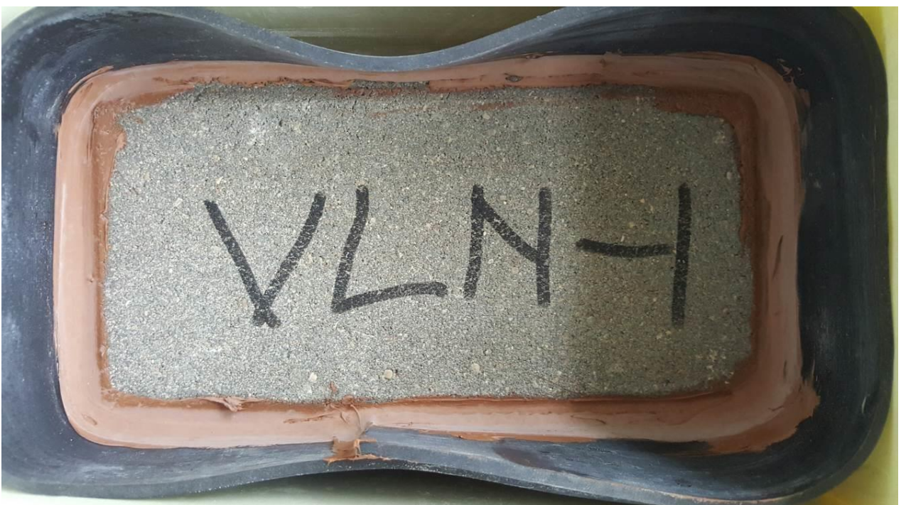
1 att. VLN-1 bruģis pirms saldēšanas pārbaudes (augšā) un pēc 72 pārbaudes diennaktīm (apakšā)
