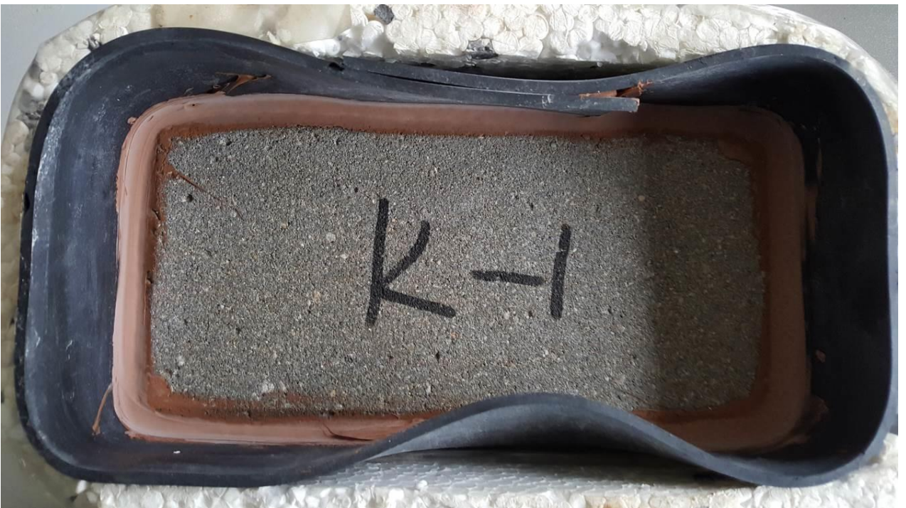
7 att. K-1 bruģis pirms saldēšanas pārbaudes (augšā) un pēc 72 pārbaudes diennaktīm (apakšā)
