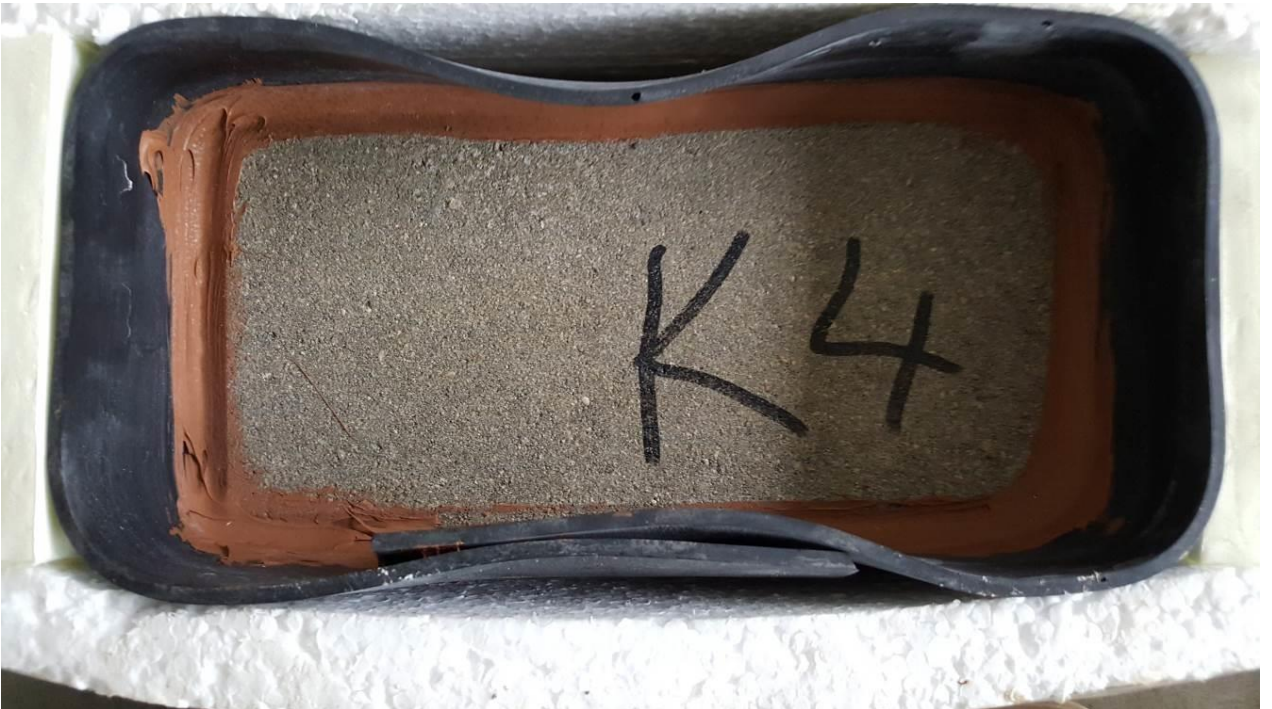
10 att. K4 bruģis pirms saldēšanas pārbaudes (augšā) un pēc 72 pārbaudes diennaktīm (apakšā)
