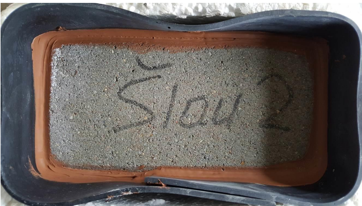
6 att. Šiau2 bruģis pirms saldēšanas pārbaudes (augšā) un pēc 72 pārbaudes diennaktīm (apakšā)
